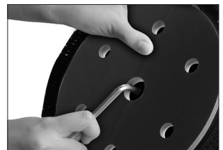
Losmaken van de schuurplaat
