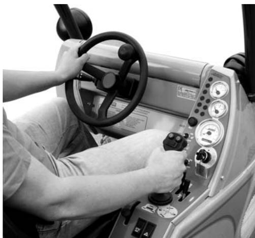
La serie 700 della minipala AVANT e' dotata di una guida idrostatica, che e' variabile a seconda dello spostamento delle pompe idrauliche nel circuito di guida. Il flusso dell'olio di queste pompe e' comandato dai due pedali di guida. I pedali di guida agiscono in maniera proporzionale dal controllo della velocita' di guida e la potenza disponibile del motore.
