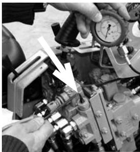
**Ausiliari Idraulici:** La pressione per gli accessori idraulici esterni e' regolabile sempre dai distributori (vedi foto) con il registro posto in basso al distributore ruotando verso in senso orario per aumentarla o antiorario per abbassarla.
