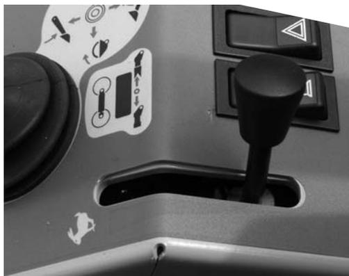
**ATTENZIONE !** AVANT 750 e. dotata di due tipi di velocita', si raccomanda l'inserimento delle velocita' sempre a bassi regime motore (vedi pag. 15) e per l'inserimento bisogna pigiare il bottone posizionato sul cruscotto vicino allo Joystick.
