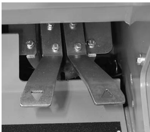
Quando pensate alla funzione dei due pedali, dovrete paragonarli ad un ingranaggio, non come a dei PEDALI NORMALI. Non premete percio' subito i pedali all'accensione della macchina. Percio' dovete premere i pedali solo quando la macchina e' accesa in modo graduale. Mollando i pedali la macchina si ferma automaticamente e il motore rimane acceso. **La figura a sx mostra i pedali delle SERIE 700 con la regolazione dell'avanzamento via valvola pilota.**
