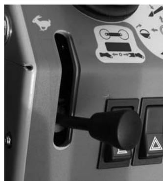
Per controllare la velocita' usate la leva a mano(foto) Non effettuare bruschi sterzi se la velocita' e' elevata.
