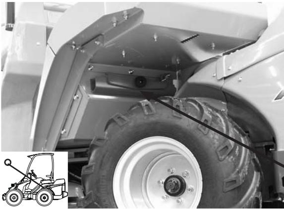
La tanica dell'olio idraulico e' situata sull'asse frontale e per controllare l'asta di livello olio e sostituire il filtro olio dovete rimuovere il blocchetto per il service che si trova agganciato alla piastra, e fissarlo sul cilindro per assicurare che il braccio rimanga bloccato in alto
