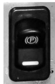
Il freno di stazionamento si inserisce automaticamente quando la macchina si spegne, il freno puo' essere sbloccato quando la macchina riparte e non risulta pressione nell'impianto.
