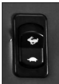
Con la velocita' ridotta si ha il massimo della forza di tiro, con la velocita' elevata solo il 50%, questa ultima serve solo per lunghi trasferimenti dove la forza di tiro non e' necessaria.
