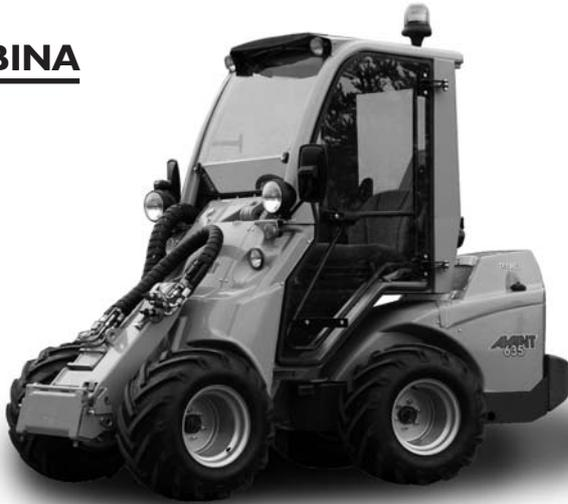
AVANT 700 può essere equipaggiata con tre diverse tipologie di cabine, qui puoi vedere alcune specifiche e dotazioni delle cabine solo la LX e DLX hanno il riscaldamento.
